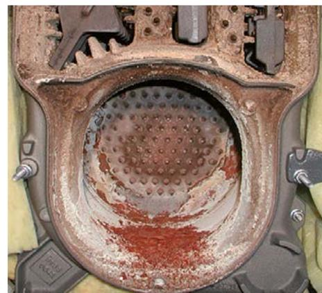
Chambre de combustion d'une chaudière après 1800 heures de fonctionnement (durée de fonctionnement moyen d'un chauffage en Suisse par an) dues à la combustion de mazout de qualité Euro.
