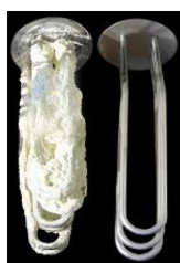
Corps de chauffe électrique, avant et après le détartrage. C'est une résistance électrique qui s'échauffe au passage de l'électricité.
